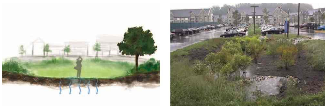
Ryc. 7 Przykład zbiornika chłonnego odbierającego wodę z ulic i parkingu, (Iwona Wagner, 2014)
