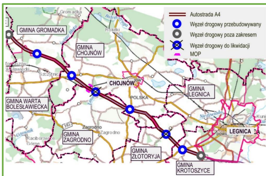
Rysunek 6. Projekt przebudowy/likwidacji węzłów autostradowych w ciągu autostrady A4 (odcinek Krzyżowa - Legnica Południe), materiały GDDKiA ze spotkania informacyjnego dla Gminy Chojnów i Gminy Zagrodno, grudzień 2022.r.
